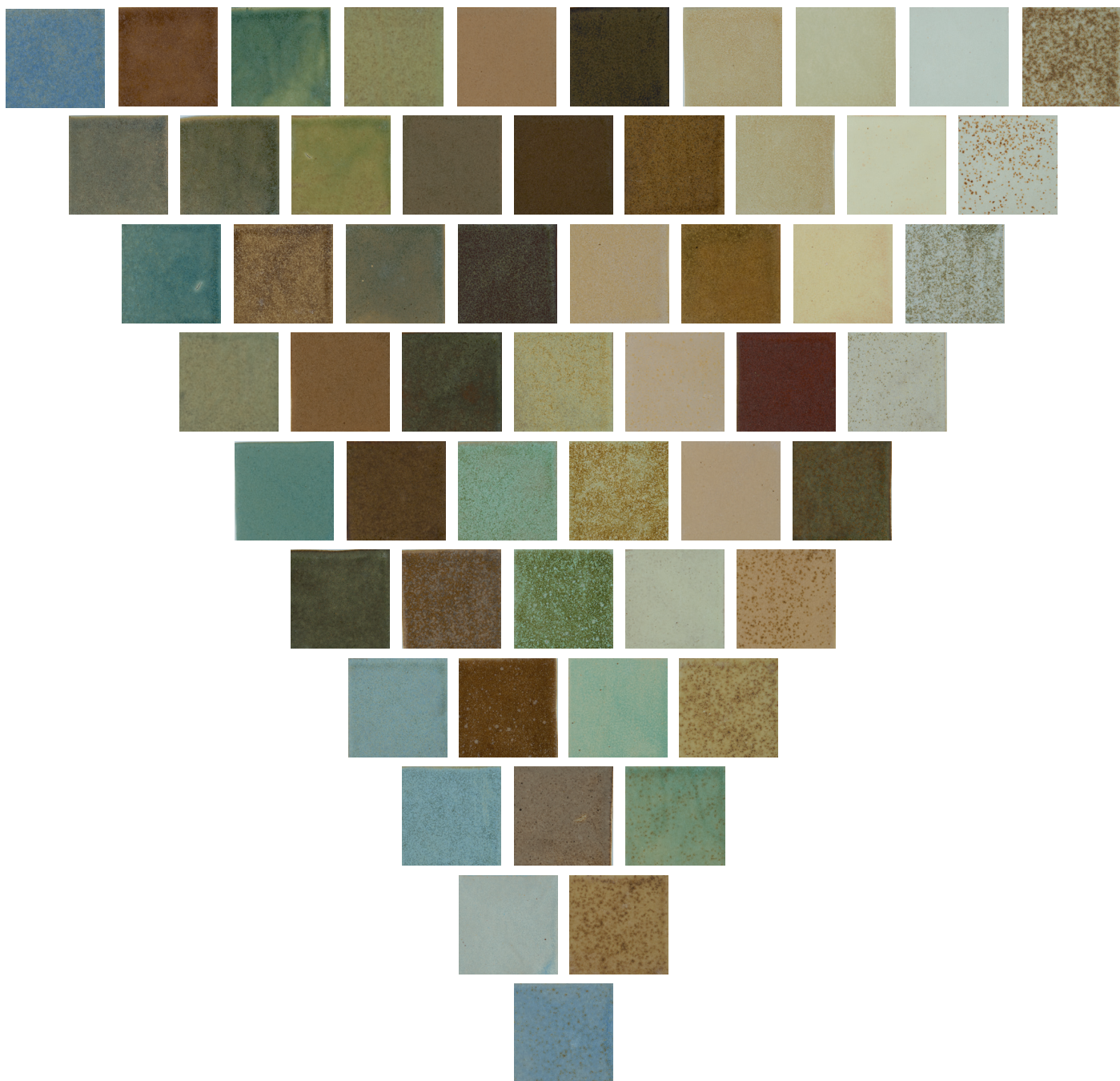
Praktische uitvoering van de multimengmethode waarbij een mat basisglazuur, MgM, gebruikt werd.
